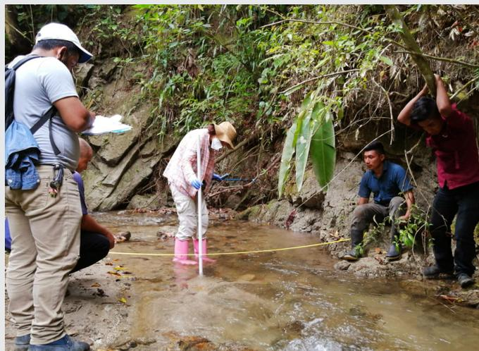
Medición de caudales en los puntos de muestreo
