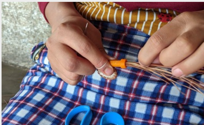
Fotografía 8. Guías impresas en 3D para facilitar el trabajo manual e implementación de mejoras en la calidad del tejido de pino para el grupo artesanal de Huité, Zacapa. Estas generaron una gran receptividad por parte de las artesanas, quienes valoraron el apoyo
