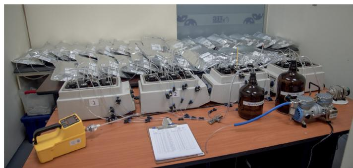
Figura 2. El sistema de biodegradación se construyó con base en la norma ASTM D5338-98. Cuenta con una bomba de aire conectada a un filtro de CO<sub>2</sub> y un humidificador. Luego, el aire pasa por los reactores, los cuales se encuentran sumergidos en 4 baños María (50°C). Finalmente, el aire de escape es almacenado en bolsas de muestreo de gases, las cuales fueron analizadas diariamente para determinar la concentración de CO<sub>2</sub>. Fuente: elaboración propia.
