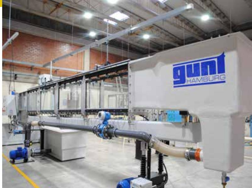
Canal hidráulico en el Laboratorio de Operaciones unitarias
